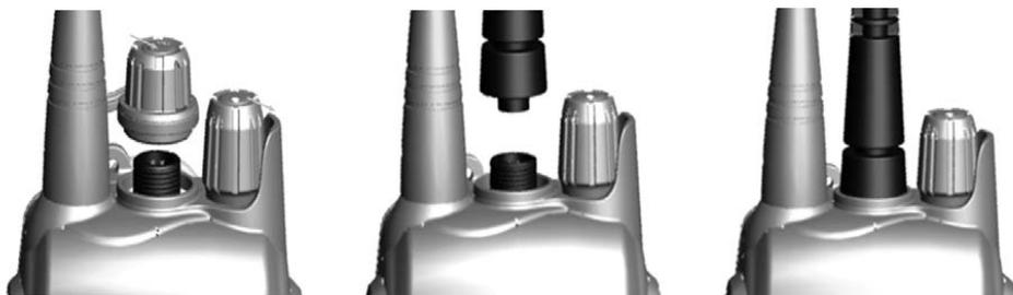
Рисунок 2 – Подключение кабеля зарядного устройства к радиостанции.
