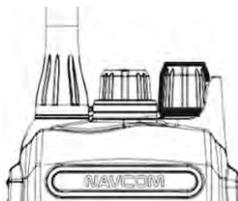
Для включения радиостанции необходимо повернуть ручку по часовой стрелке до щелчка. При включении радиостанции должен прозвучать сигнал подтверждения. Для увеличения громкости приема необходимо при включенной радиостанции повернуть ручку по часовой стрелке, а для уменьшения громкости, соответственно, повернуть ручку против часовой стрелки. Для выключения радиостанции необходимо повернуть ручку против часовой стрелки до щелчка.
