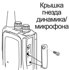
Если вы не используете динамик/микрофон, установите крышку на гнезда динамика/микрофона, используя прилагаемый винт 3 x 6 мм.
